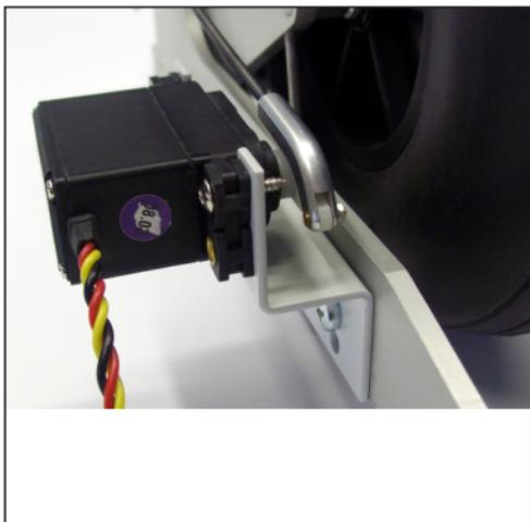
Dieser Servohalter löst das Problem der schrägen Anlenkung zum Aus- und Einfahren des EZFW. Das Servo kann liegend montiert werden, wodurch Servohebel und Anlenkung exakt parallel verlaufen, und so das Servo entlasten. Die Bohrungen sind passend zu FEMA Fahrwerken, der Halter kann aber auch an anderen Fahrwerken verwendet werden.
