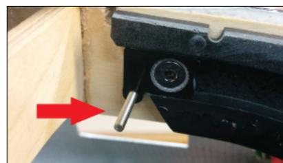
AFT ausfahren (ohne Antriebsakku), im letzten 1/3 des Ausfahrweges den Arm mit der Hand etwas bremsen, um Fahrtwind zu simulieren, aber das AFT bis zum Ende ausfahren lassen. Jetzt muss der Schalter gedrückt sein und auch gedrückt bleiben. Dann muss der Arm in alle Richtungen bewegt werden, dabei ist darauf zu achten, dass der Schalter immer geschlossen bleibt. Durch Aufstecken eines dünnen Schlauches auf den Schaltgeber kann der Schaltpunkt verändert werden.
