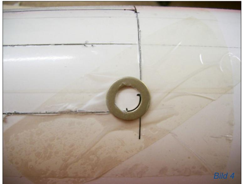
2. Das Heraustrennen der Klappen funktioniert wie folgt: Markieren Sie als erstes die Anordnung der Klappen (links-rechts-vorne-hinten). Begonnen mit dem Schnitt wird am besten mit der Mittellinie. Legen Sie das Stahllineal an die Mittellinie und fixieren Sie es mit Klebeband. Das Lineal dient als Führung für das Messer. Drehen Sie das Messer wie auf [Bild 5](#) ersichtlich auf den Rücken und ritzen Sie mit der Kante des Messers immer wieder entlang am Lineal auf der Linie.
