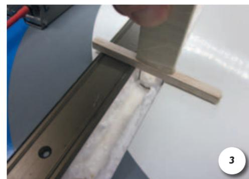
Ein selbst gebauter Schneiddraht verschafft der Störklappe Platz im Styropor
