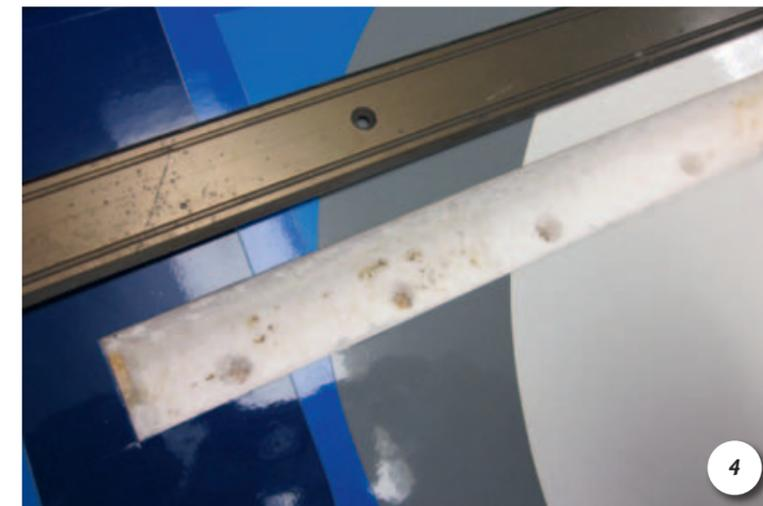
Löcher, die bis zur Unterschale reichen, sorgen über den Kleber für kraftschlüssigen Halt der Mechanik
