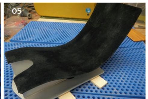
**01+02** | Die Motorattrappe verkleidet den kleinen Elektromotor sehr vorbildgetreu **03** | Auch in großen Rümpfen kann es schon mal eng zugehen, wenn erst einmal alles eingebaut ist **04+05** | Der Pilotensitz wird aus ein paar Frästeilen aufgebaut und auf dem Rumpfboden verschraubt
