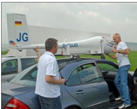
Der Dachtransport: Der Rumpf ruht auf zwei Halbspannen im Freien. Ihm macht ein kurzer Regenschauer nichts aus
