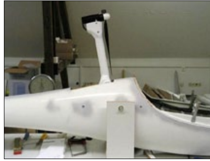
Das Klapptriebwerk wird eingemessen. Der Rumpf ist in Fluglage aufgebockt und zeigt deutlich, wie das Klapptriebwerk in ausgefahrener Stellung schräg nach hinten geneigt ist, um das Nickmoment auszugleichen
