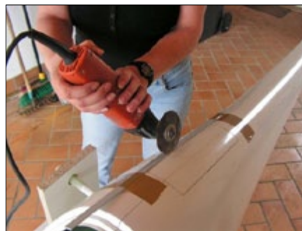
Große Modelle erfordern große Werkzeuge: Der Klappenschacht wird ausgefräst
