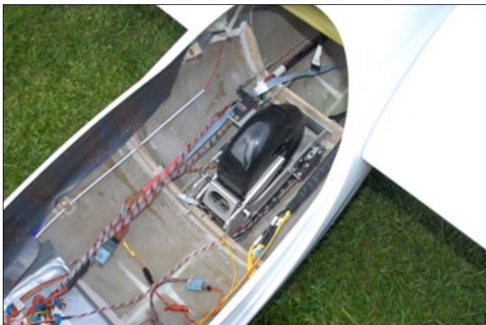
Auch bei den Spanten wurde gezeigt. Einfach einen „dicken“ Ringspann hinter dem Fahrwerk einsetzen, der auch die Steckung abstützt, davon ist man bei einem solchen Projekt weit entfernt
