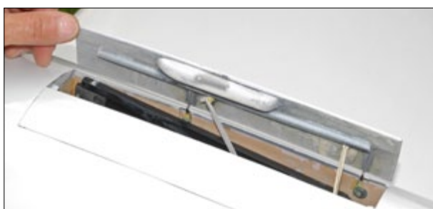
Sorgenkinder: Bis die Triebwerksklappen spaltfrei saßen und sicher öffneten bzw. schlossen, verging fast eine Woche
