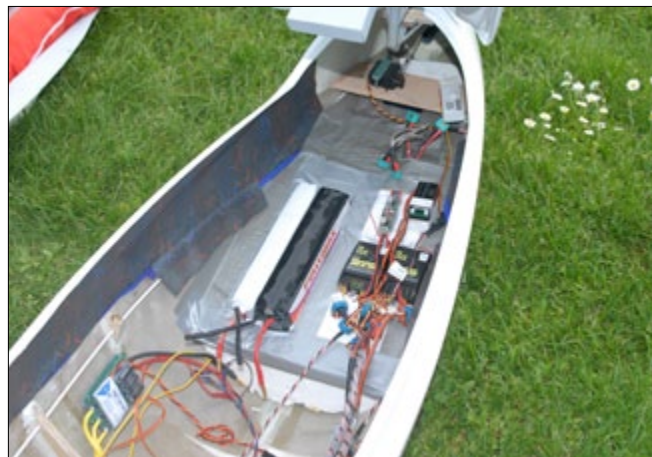
Was sich unglaublich groß anhört, verliert sich später fast schon im Rumpf: Das 10s-LiPo-Paket aus 5300er-Zellen. Direkt daneben die beiden Diversity-Empfänger von ACT
