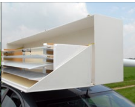
Die vier großen Tragflächenteile werden hingegen in dieser Kiste transportiert. Nach Öffnen der Kiste klappen sie zusammen aus der Seitenwand heraus und lassen sich prima ein- und ausladen
