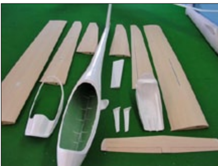
Das sind die Teile, die mir Rosenthal angefertigt hat: Das hier gezeigte Seitenruder wurde später noch durch ein extrem leichtes im Eigenbau ausgetauscht
