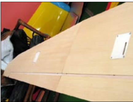
Sechs Tragflächenteile in Abachi-beplankter und CfK-verstärkter Styrotechnik waren zu erstellen. An die 2,6 m langen Innenflächen sind die kurzen bzw. langen Außenflächen anzustecken, wodurch die Spannweite zwischen 7,5 und 9 m variiert
